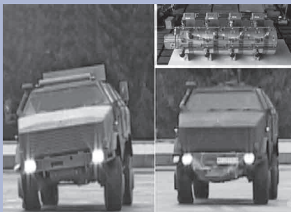
Aktives Fahrwerk in einem 12t-Geländefahrzeug; links herkömmliches und rechts aktives Fahrwerk während Kreisfahrt; oben rechts: Flügelzellenpumpen
