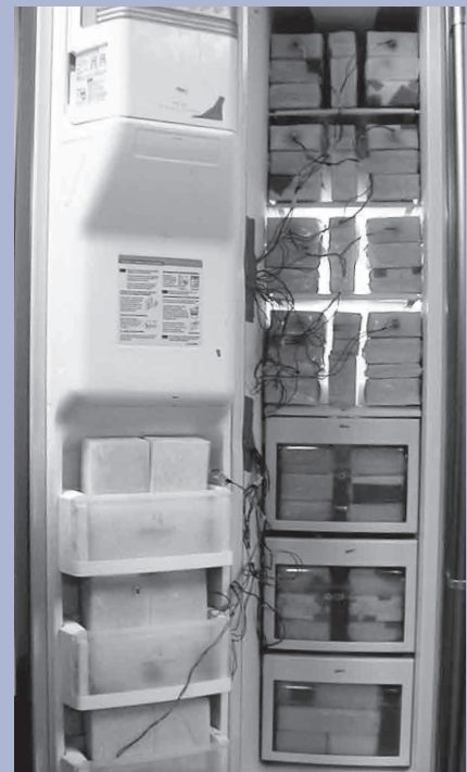
Beladung eines Gefrierfachs mit Testpaketen
