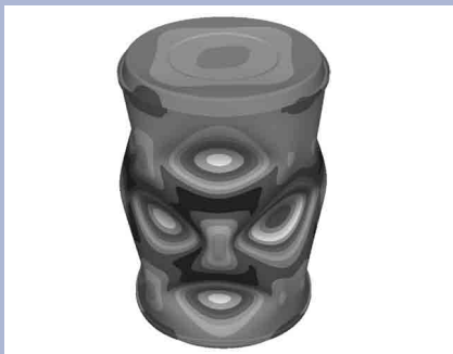
Untersuchung des Beulverhaltens eines Kunststoff-fasses bei Vertikalbelastung
