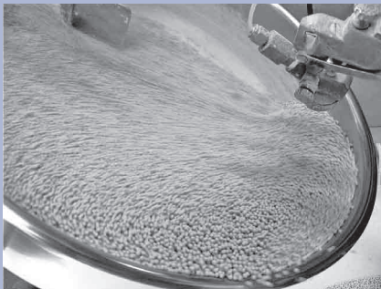
Die Produkteigenschaften disperser Systeme lassen sich durch genaue Kenntnis der interpartikulären Wechselwirkungen und gezielte Kontrolle der Prozessparameter für verschiedenste Anwendungen optimieren. So eröffnen sich effizientere Wege für Transport und Verarbeitung sowie völlig neue Anwendungsfelder längst bekannter Stoffe. (Bild: Modifizierung der Produkteigenschaften von Kalksteinmehl in einem Granulierteller).
