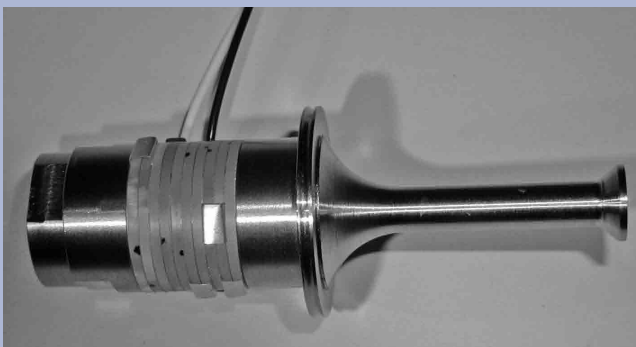
Vorgespannter Ultraschallaktor mit Scheiben aus LiNb-Einkristall
