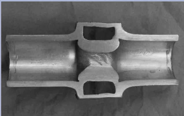
Im Reibdruckprozess erzeugte Hohlstruktur
