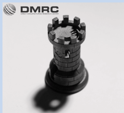
Mittels pulverbasierter Fertigungsverfahren können auch komplexe Bauteile in nur einem Prozessschritt direkt aus CAD-Daten erzeugt werden.
