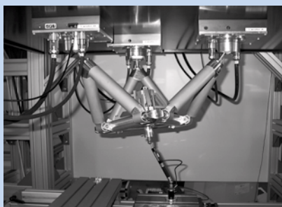
Parallelroboter TriPlanar mit Messvorrichtung zur Selbstkalibrierung
