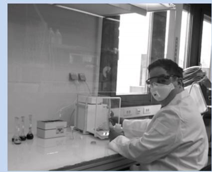
Präparation von Nanopartikel-Proben in mobiler staubfreier Umgebung (FlowBox).
