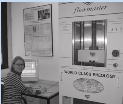
Untersuchung von Wandgleiteffekten an einem modifizierten Hochdruck-Kapillarrheometer.
