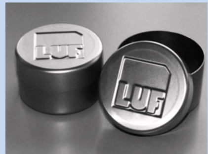
Musterwerkstücke (Multibrän Verfahren, d.h. Umformen, Prägen und Schneiden in einem Werkzeug und Arbeitsgang)
