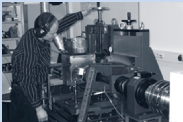
Messung der Rückstellkräfte von Bogenzahnkupplungen
