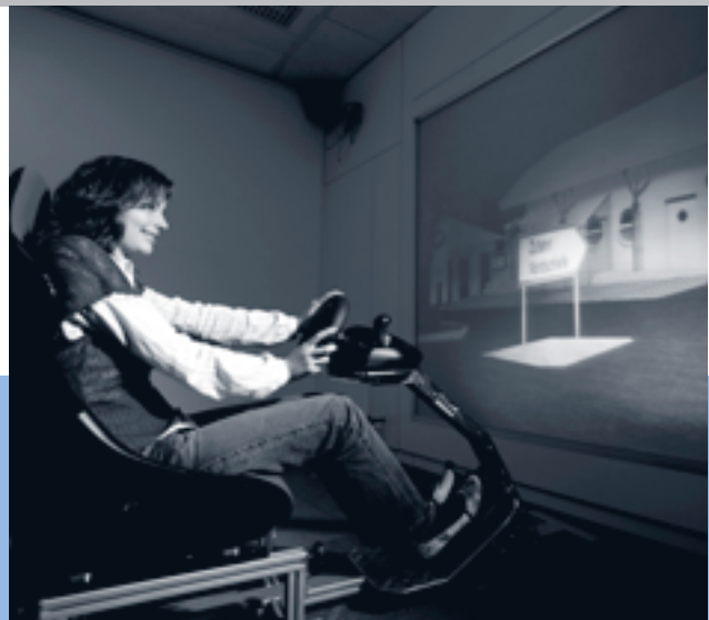
Virtual Prototyping von Scheinwerfersystemen mit dem Nachtfahrsimulator Virtual Night Drive
