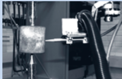
Erfassung der Schädigung mittels eines Wirbelstromsensors
