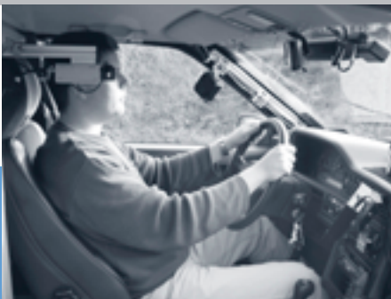
Oben: Versuchsfahrzeug mit Eye-Tracking System
