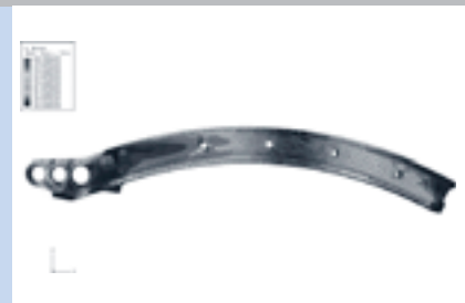
Bruchmechanische Werkstoffkennwertermittlung und Rissausbreitungsanalysen für einen Slat Track (Flugzeugkomponente) mit dem Ziel der Designoptimierung und des Leichtbaus
