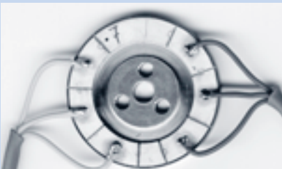
Segmentierte Piezokeramik auf der Unterseite des Stators eines Wanderwellenmotors
