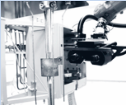
Automatische 3D-Vermessung einer deformierten Struktur
