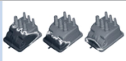
Simulation des Gelierprozesses bei der Herstellung eines Schaltergehäuses aus Epoxidharz
