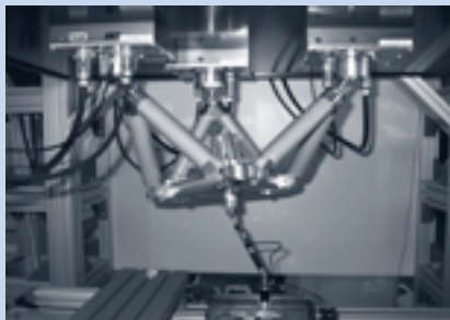
Parallelroboter TriPlanar mit Messvorrichtung zur Selbstkalibrierung
