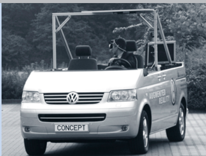
Die „Mobile Augmented Reality Versuchsplattform“: Reales Fahrzeug und virtueller Innenraum verschmelzen zu einem neuen Prototypen (Foto: Jan Braun/HNF)
