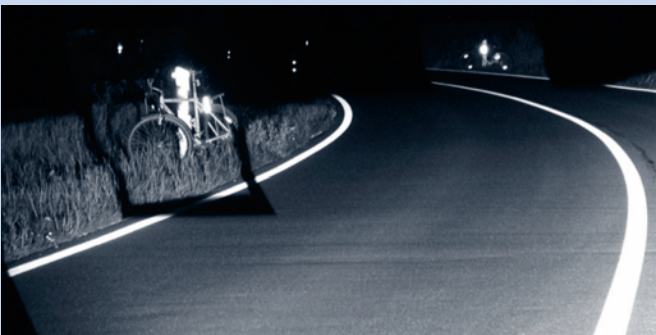
Oben: Hervorheben eines Fahrrades am Straßenrand durch aktives Licht
