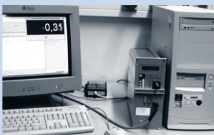
Schädigungsuntersuchungen bei Thermochockexperimenten: Einsatz des Wirbelstromverfahrens bei der Schädigungsanalyse von zyklischen Thermochockexperimenten und typische Messergebnisse
