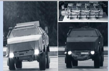
Aktives Fahrwerk in einem 12-t-Geländefahrzeug; Vergleichsfahrt: herkömmliches und aktives Fahrwerk; oben rechts: Pumpeneinheit zur Versorgung des Fahrwerks
