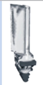
Finite-Element-Berechnung der Vergleichsspannung in einer Gasturbinenschaufel
