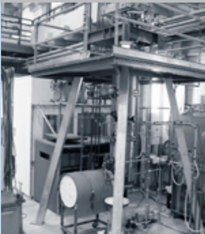
Hochleistungsreaktor zur Entgasung von flüchtigen Bestandteilen aus Polymerschmelzen
