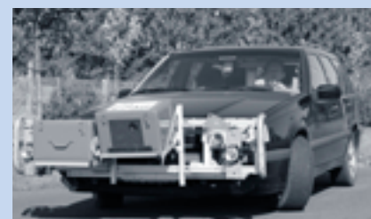
Das von Jacek Roslak und Rainer Kauschke entwickelte System zur blendungsfreien Ausleuchtung des Verkehrsraumes, basierend auf einem aktiven DMD-Scheinwerfer (Digital Micromirror Device) in Kombination mit einem vorausschauenden Sensor.
