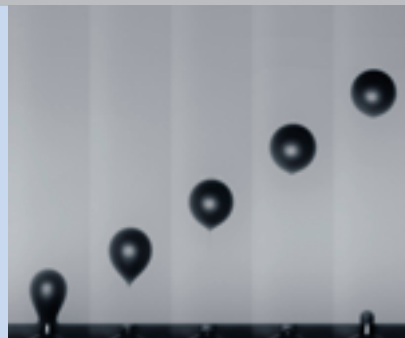
Abreißen von Dampf-/Gasblasen geschieht durch Einschnüren der Blase am Fuß. Je nach Stoffwerten der Phasen bildet sich in Grenzfällen ein Flüssigkeitsstrahl durch die Blase oder ein Gasfaden hinter der Blase aus.
