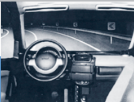
Oben: Der Nachtfahringsimulator im L-LAB
