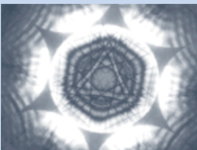
Mikrostrukturelle Werkstoffuntersuchung (Bsp.: Konvergente Elektronenbeugung)
