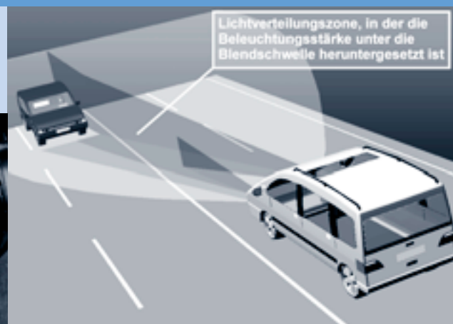
Oben: Kollektive Ausleuchtung der Fahrbahn (L-LAB)
