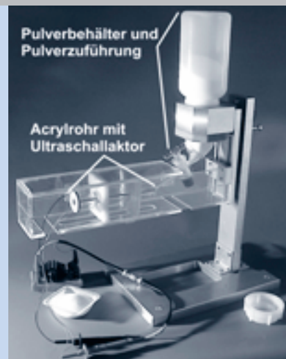
Technologiedemonstrator zum Pulvertransport durch Ultraschall
