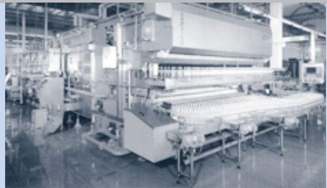
Die ökonomische und ökologische Optimierung des Tensid- und Wassereinsatzes in Flaschenreinigungsanlagen mit Kapazitäten bis zu 120.000 Flaschen/Stunde zählt zu den aktuellen Forschungszielen.
