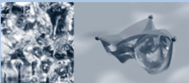
Bild: Blasenbildung im Experiment und in der Computersimulation
