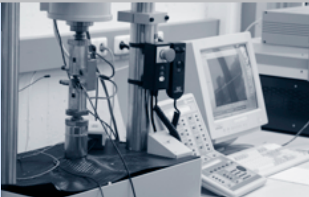
Versuchseinrichtung zur Durchführung von Ermüdungsrissausbreitungsversuchen
