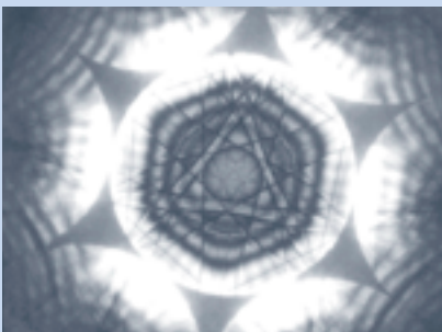
Mikrostrukturelle Werkstoffuntersuchung (Bsp.: Konvergente Elektronenbeugung)
