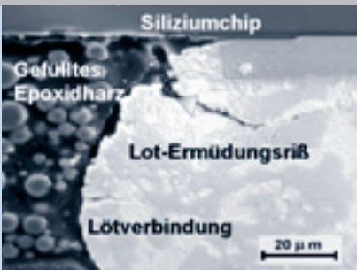
Gekrümmter Ermüdungsriß in einer Lot-Verbindung
