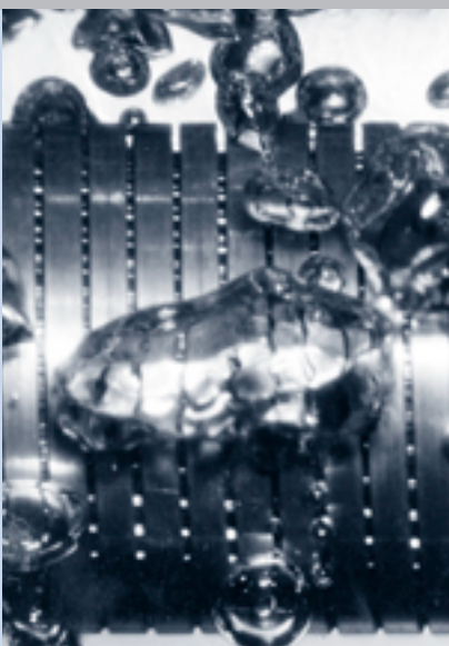
Wärmeübertragung an umweltfreundliche Kältemittel und Kohlenwasserstoffe Hochleistungsverdampferrohr mit Öffnungen von ca. 0,2 mm Breite zwischen den Rippenaußenflächen.
