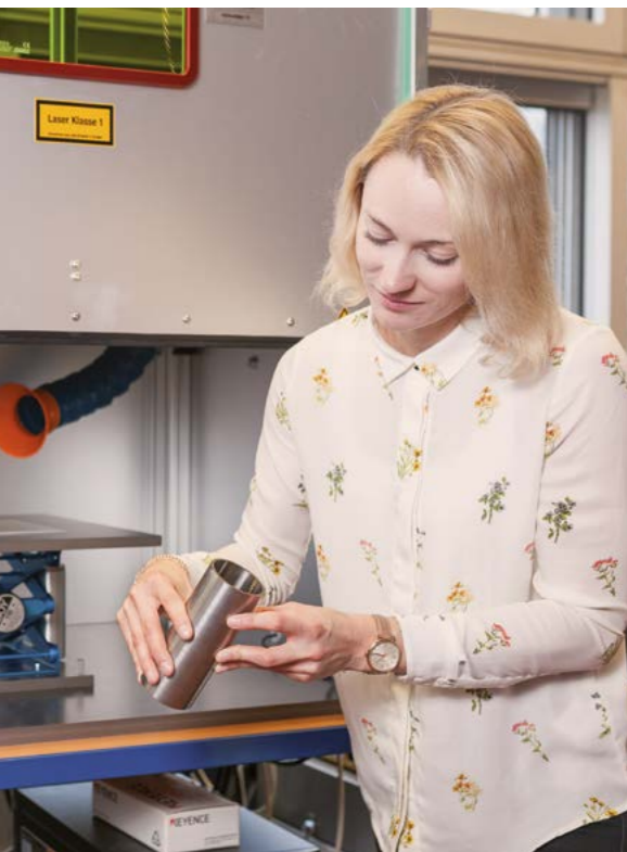
Durch die automatische Fokusanpassung ermöglicht das 3D-Lasersystem eine gleichmäßige Strukturierung dreidimensionaler Bauteile. (Foto: Jan Olaf Scholz | Film & Foto; www.joscholz.com)
