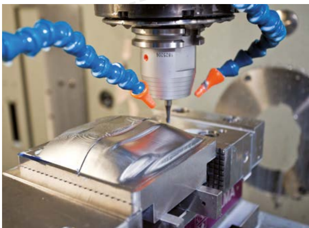
3D-Fräsbearbeitung von komplexen Werkzeuggeometrien zur Herstellung von genormten Blechbauteilen
