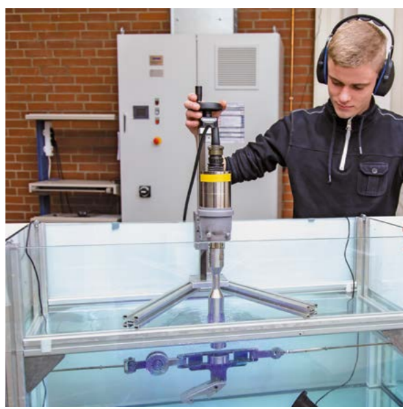
Reinigung von verschmutzten Förderketten mittels akustischer Kavitation
