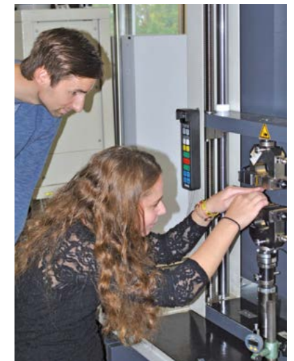
Zugprüfung an einer Kunststoffprobe zur Bestimmung der mechanischen Zugeigenschaften
