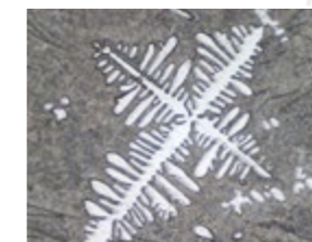
Lichtmikroskopische Aufnahmen einer Silber-Calcium- (l.) und einer Silber-Lanthan-Legierung (r.)
