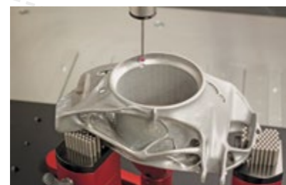
Mit dem Laserschmelz-Verfahren gefertigter Radträger wird auf der Koordinatenmessmaschine vermessen.
