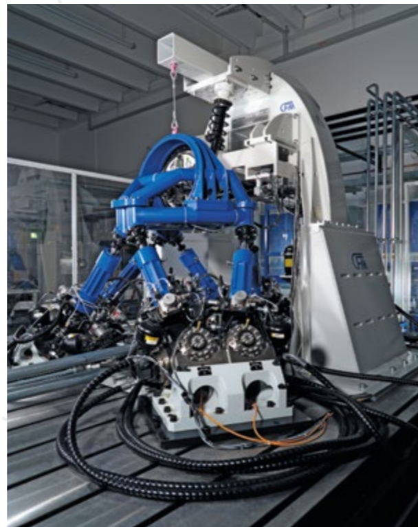
Prüfstand zur Hardware-in-the-Loop (HiL)-Simulation mechatronischer PKW-Achsen (© Heinz Nixdorf Institut)
