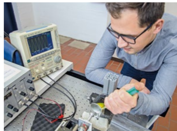
Wasserzerstäubung in einem optimierten Ultraschall-Stehwellensystem
