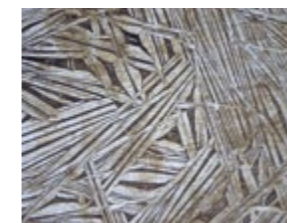
Lichtmikroskopische Aufnahmen einer Silber-Calcium- (l.) und einer Silber-Lanthan-Legierung (r.)
