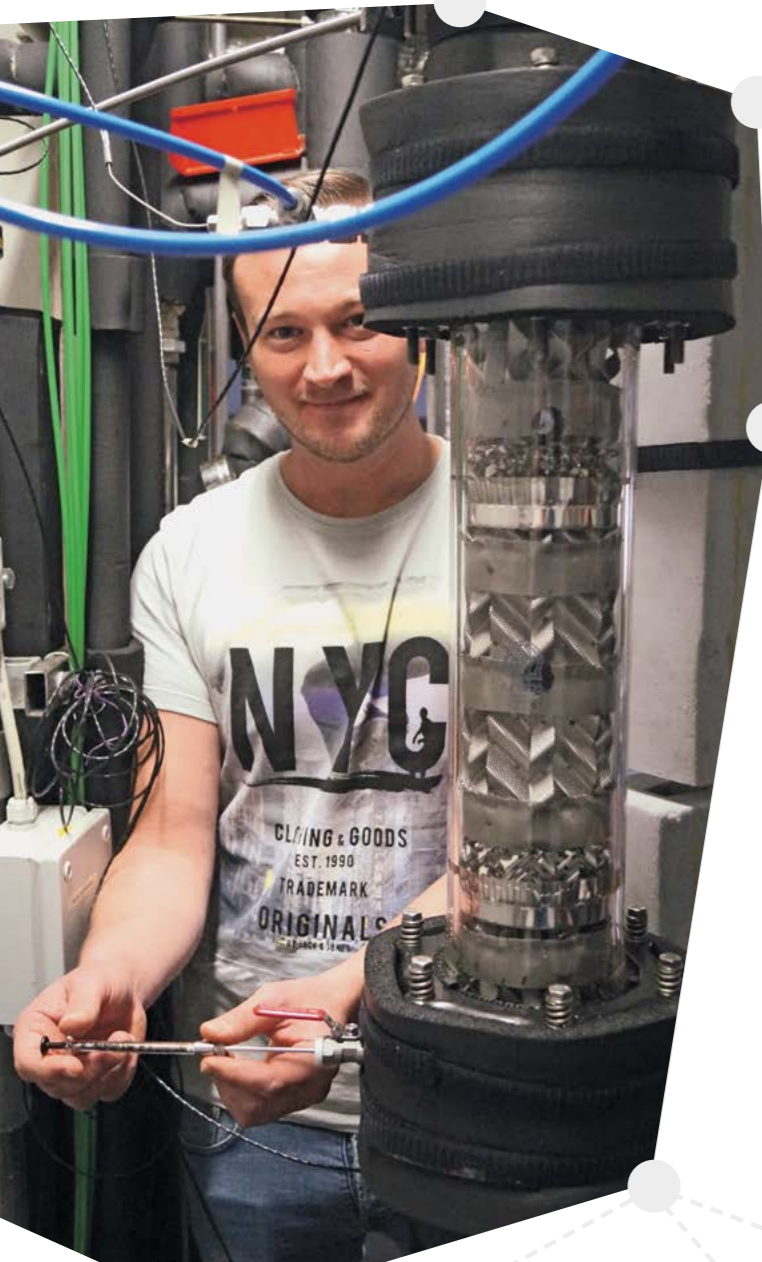
Probenahme zur Untersuchung des CO 2 -Abscheidungsverhaltens verschiedener strukturierter Packungen
