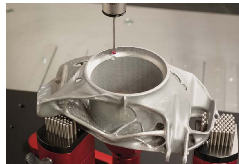
Mit dem Laserschmelz-Verfahren gefertigter Radträger wird auf der Koordinatenmessmaschine vermessen.
